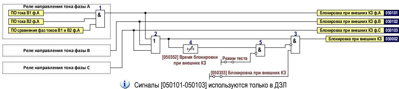
Рисунок К.3 Внутренняя логическая схема органа блокировки при внешних КЗ
